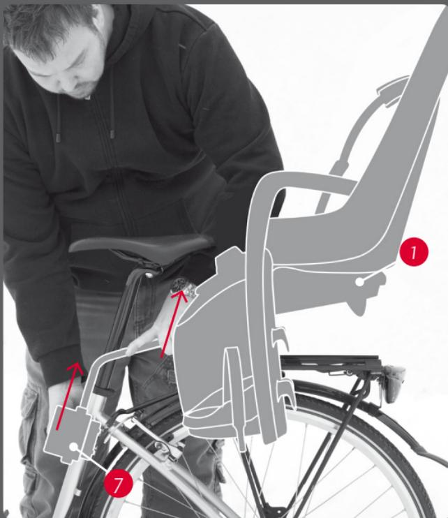
**FR** Le siège est facile à enlever lorsque la bicyclette n'est pas utilisée. Appuyez sur le couvercle de l'étrier et retirez la barre du siège de l'étrier (7).
